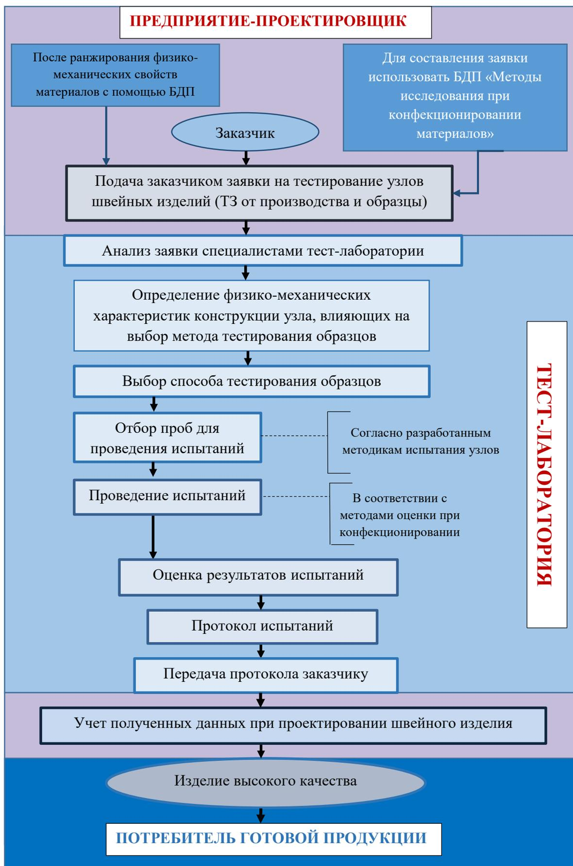
Рисунок 1.10 - Процедура тестирования узлов швейных изделий в системе цифрового проектирования
