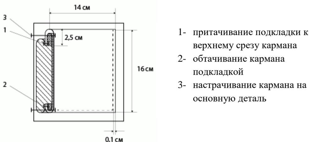
Рисунок 3.1 – Устройство узла «деталь швейного изделия с накладным карманом»
