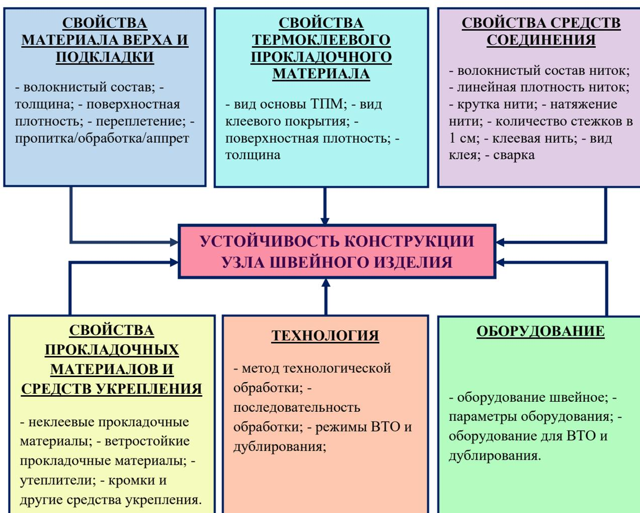
Рисунок 2.9 - Влияние производственных факторов на устойчивость конструкции узла швейного изделия
